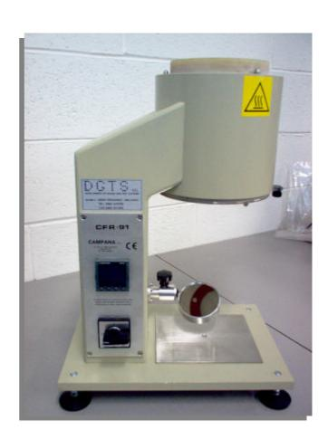
II M.F.I. tipo CFR, rispondente alle vigenti norme UNI 5640, ISO R 1133, DIN 53735, ASTM D 1238 e BS 2782, è in grado di determinare in semplice e pratico, l'indice di fluidità o "Grado" o "Melt Index" su provini di polimero termoplastico.
